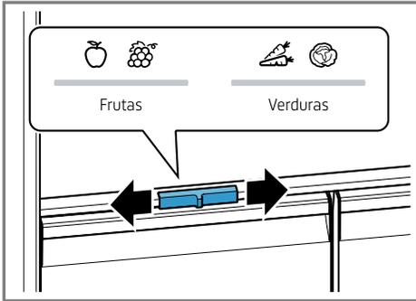
Deslizar el regulador de humedad para ajustar la humedad del aire en el cajón para fruta y verdura en función de la naturaleza y la cantidad de alimentos que se vayan a guardar en el mismo:
