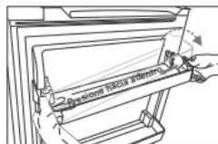
Instalación del balcón de la puerta
