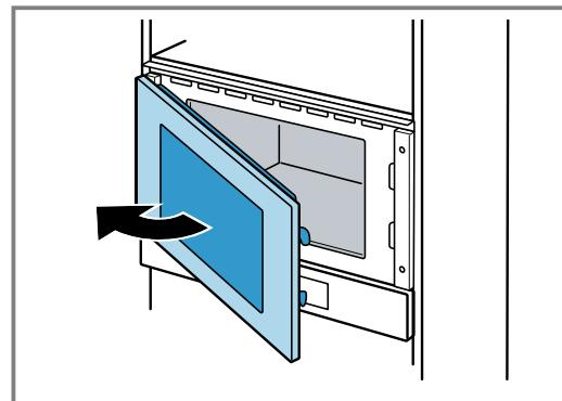
4. Aparafusar o aparelho ao móvel do lado oposto das dobradiças.
