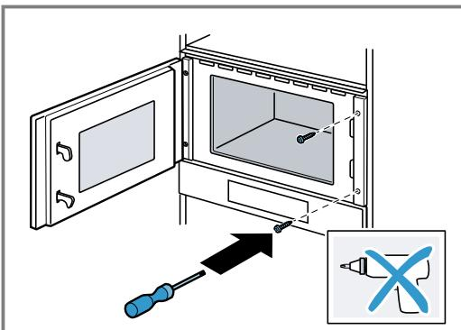
5. Abrir previamente os furos para o aparafusamento do lado das dobradiças no móvel.
