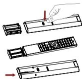
1. Pulse el interruptor y la caja de la batería aparecerá automáticamente.
