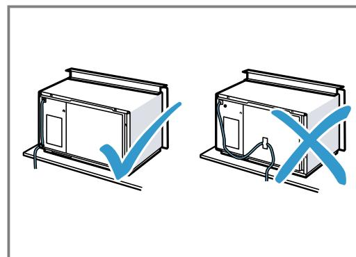
Τοποθετήστε τη συσκευή στο ντουλάπι και οπρώξτε τη προς τα δεξιά.
