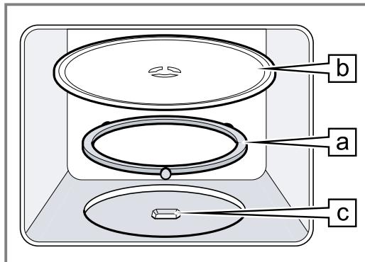
2. Döner tablayı **b**, pişirme bölümü tabanının ortasındaki **c** tahrığıne oturtunuz.
