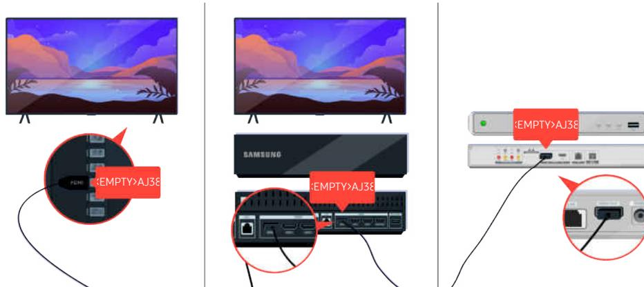
Si continúa el mismo problema, intente conectar otro dispositivo externo al televisor con un cable HDMI. Si la visualización es correcta, es posible que su dispositivo externo esté defectuoso.
