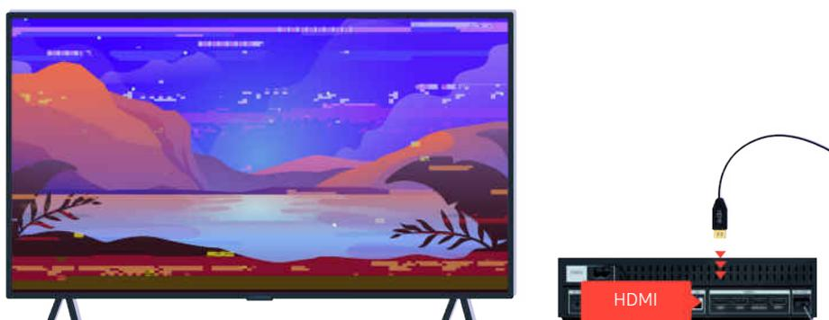
Si el dispositivo externo admite vídeo UHD, use un cable HDMI específico (4K) para la reproducción de vídeos HDMI.
